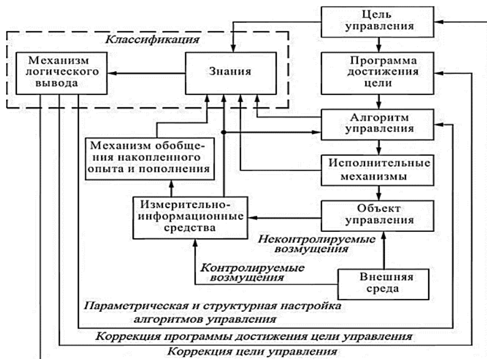
Рисунок 13 - Схема работы ИСАКиУК кондитерской продукции
