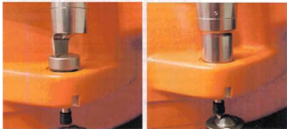
Рисунок 10 – Привинченное к измерительному патрону устройство EMD
